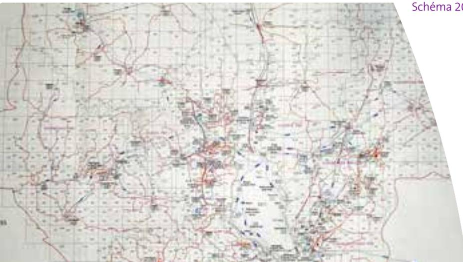
**Schéma 20** Exemple de cartes de distribution d'un réseau utilisées par le Bangladesh Rural Electrification Board pour la planification de son développement de réseau. Les cellules rectangulaires sont utilisées pour la planification de charge. Les lignes de réseau de tensions différentes sont indiquées au moyen de codes distincts. Les sous-stations de distribution primaire convertissent l'électricité de 33 kV en 11 kV.
